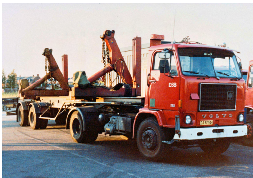
DSB Volvo F86 med sættevogn. Den blå cirkel på kølgitteret indikerer, at vognen havde forhøjet akseltryk og derfor kun måtte køre på bestemte veje - det såkaldte "blå vejnet". Skiltene udgik omkring 1980. Herning 1975. (Foto Carl-Johan Semler)
