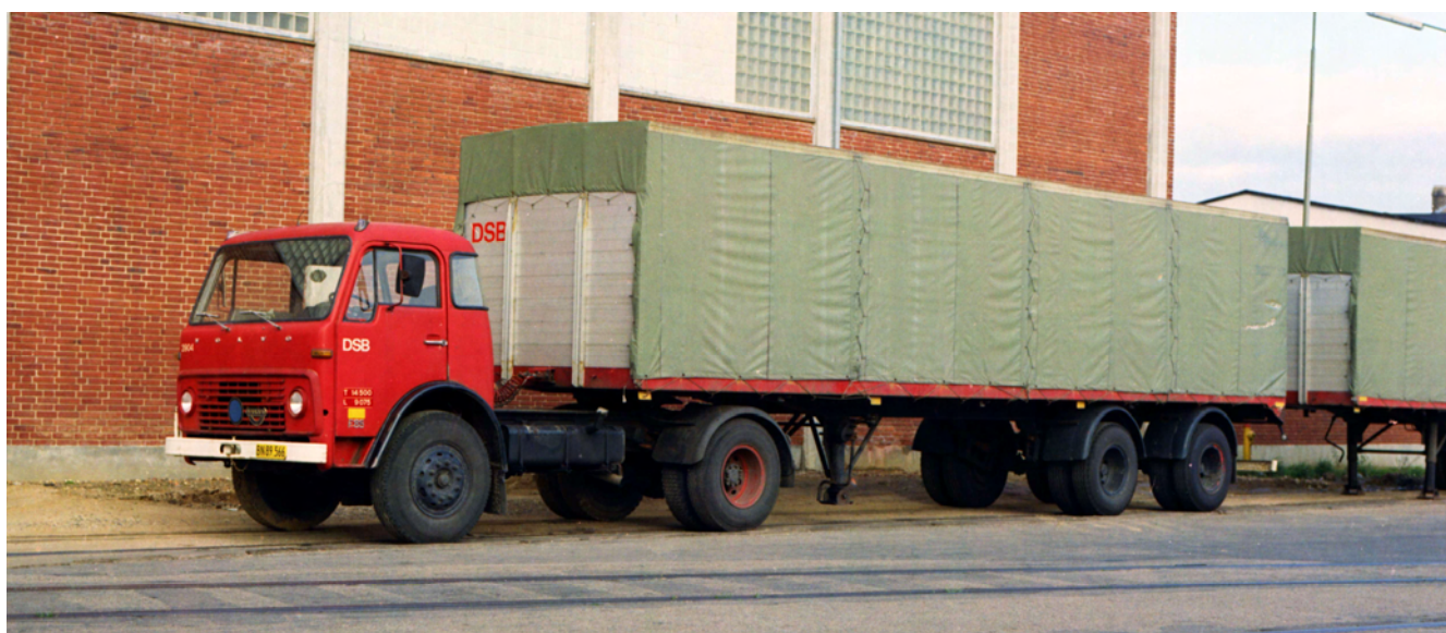
DSB Volvo F86 med sættevogn. Den blå cirkel på kølgitteret indikerer, at vognen havde forhøjet akseltryk og derfor kun måtte køre på bestemte veje - det såkaldte "blå vejnet". Skiltene udgik omkring 1980. Herning 1975. (Foto Carl-Johan Semler)
