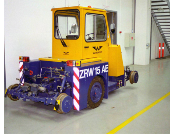
Til rangering med Metro-tog blev anskaffet denne Windhoff med såvel vej- som jernbanehjul. Ørestad 2002. (Foto Ole Gold)
