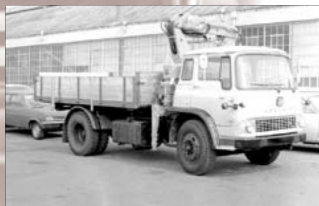
Ejeren er ukendt, men denne TK-model med læssekran, har utvivlsomt været leveret til brug ved entreprenørkørsel. Bilen er her fotograferet på samlefabrikken i Aldersrogade. (Foto GM Danmark)
