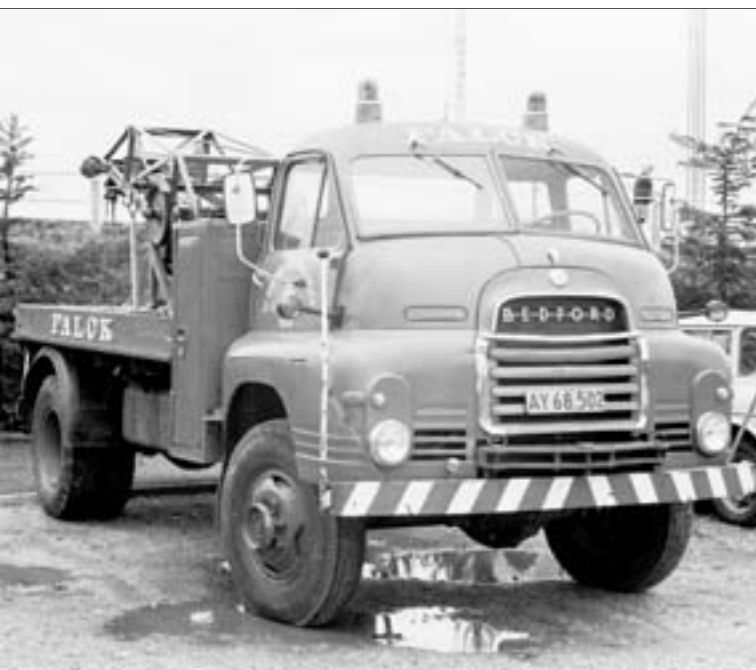
Også Falcks Redningskorps havde behov for firehjulstrukne køretøjer til bjærgningsopgaver. Falck i Køge havde denne R-model med dobbel dækmontering på bagakslen. (Foto Steen Taber Rasmussen)
