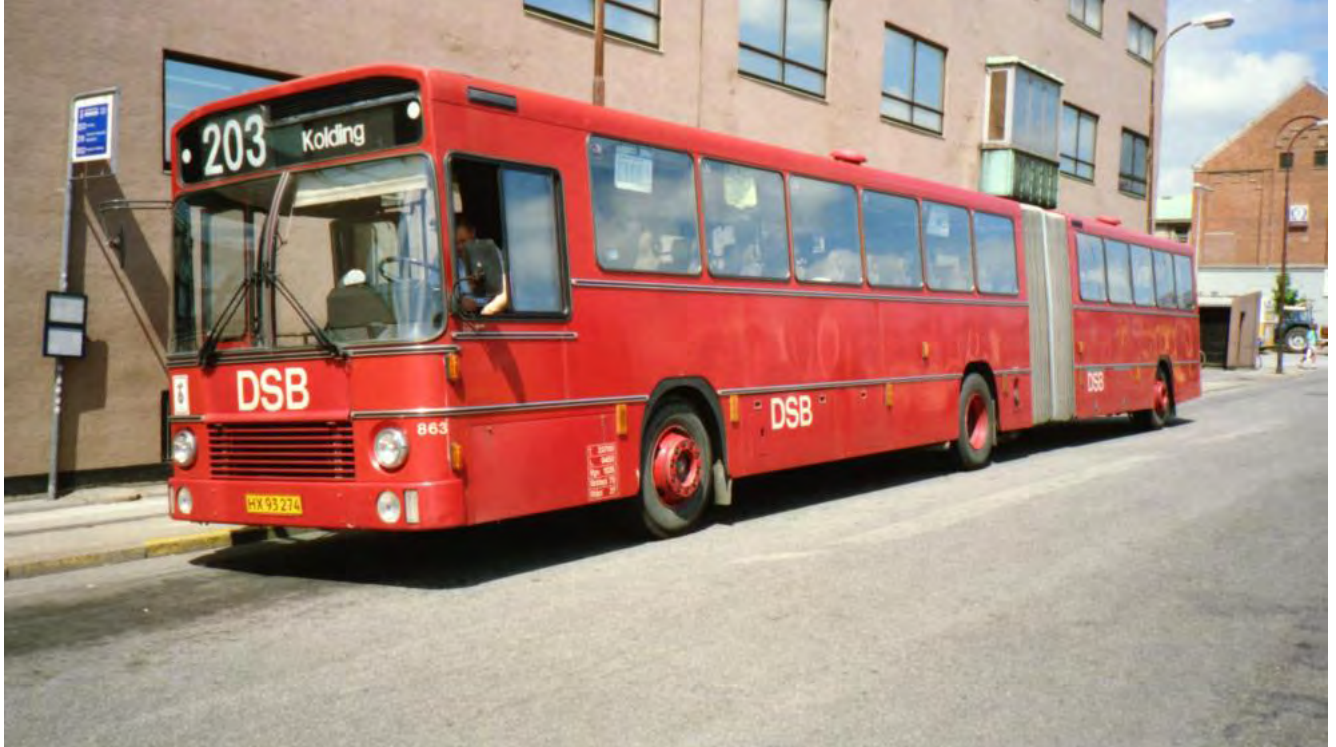
Ledbussen, der var 18 meter lang, holdt sit indtog i 1982 og blev i første omgang indsat på ruten Kolding-Vejle. Men også andre steder i landet blev denne type efterhånden indsat efter ønske fra de fælleskommunale trafik-selskaber. Her er DSBs første ledbus, en Volvo B10MA/Aabenraa øverst i Vejle og til højre i Kolding. (Foto øverst Per Kromann Jepsen og til højre Peer Goe Jacobsen)
