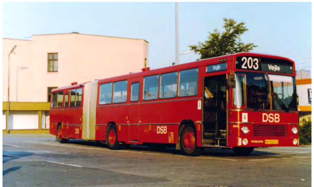
Ledbussen, der var 18 meter lang, holdt sit indtog i 1982 og blev i første omgang indsat på ruten Kolding-Vejle. Men også andre steder i landet blev denne type efterhånden indsat efter ønske fra de fælleskommunale trafik-selskaber. Her er DSBs første ledbus, en Volvo B10MA/Aabenraa øverst i Vejle og til højre i Kolding. (Foto øverst Per Kromann Jepsen og til højre Peer Goe Jacobsen)
