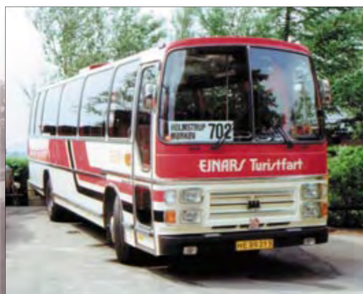
Type YMT årgang 1980. I forbindelse med trafikelskabernes og kommunernes etablering af kørselsordninger omkring 1980 dukkede et antal Bedford YMT med 54 personers Plaxtons Supreme IV-karosserier op som rutebiler på gule nummerplader. Karakteristisk med de rektangulære dobbelte frontlygter, den ligeledes rektangulære frontgrill og den sorte kofanger. Busserne tilhørte Ejnar Pedersen, Brokøb (til venstre) henholdsvis Arne Vium Jensen, Kerteminde (nederst). (Fotos Claus Hansen)
