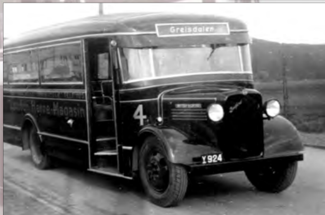
Type WTL årgang 1934 med Aagaard-karosseri tilhørende Anton Jensen, Vejle Byomnibus. At der var tale om en bus, opbygget på lastbilschassiset WTL, afslørede dels af kølerkappens manglende lodrette lameller, dels af den sortmalede kølerkappe. (Arkivfoto Jens Birch)
