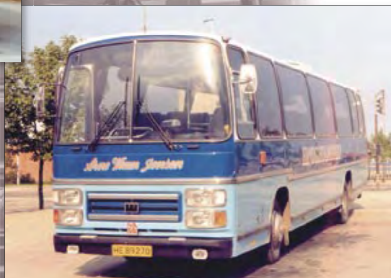
Type YMT årgang 1980. I forbindelse med trafikelskabernes og kommunernes etablering af kørselsordninger omkring 1980 dukkede et antal Bedford YMT med 54 personers Plaxtons Supreme IV-karosserier op som rutebiler på gule nummerplader. Karakteristisk med de rektangulære dobbelte frontlygter, den ligeledes rektangulære frontgrill og den sorte kofanger. Busserne tilhørte Ejnar Pedersen, Brokøb (til venstre) henholdsvis Arne Vium Jensen, Kerteminde (nederst). (Fotos Claus Hansen)
