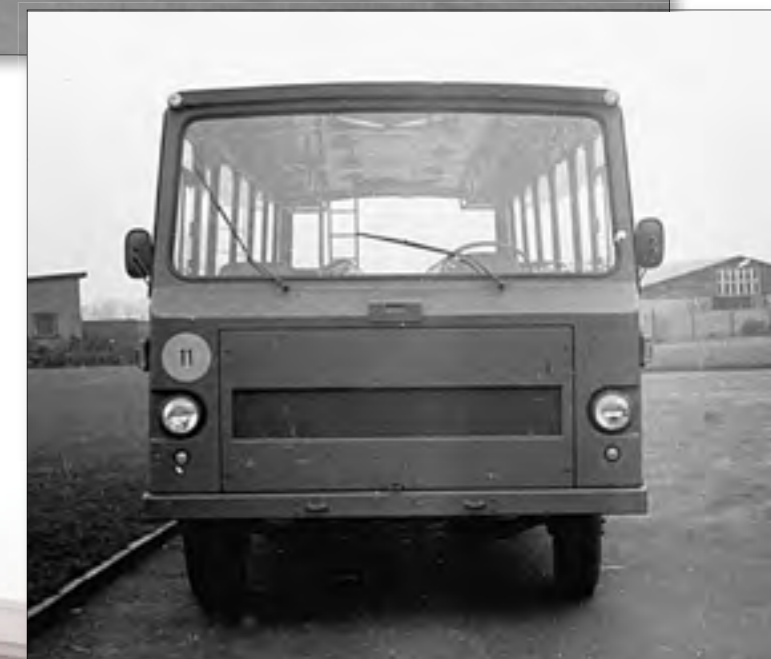
Type SB årgang 1970 med karosseri fra Ringsted Karosserifabrik. Op gennem 1960'erne og indtil 1971 anskaffede det danske forsvar mere end 70 eksemplarer af type SB – nogle med benzinmotor (SB3), andre med dieselmotor (SB5). Karosserierne blev leveret af Ringsted Karosserifabrik, som først med leverancen fra 1970 ændrede karosseridesignet til et mere moderne og samtidigt udseende. (Arkivfoto Jens Birch)
