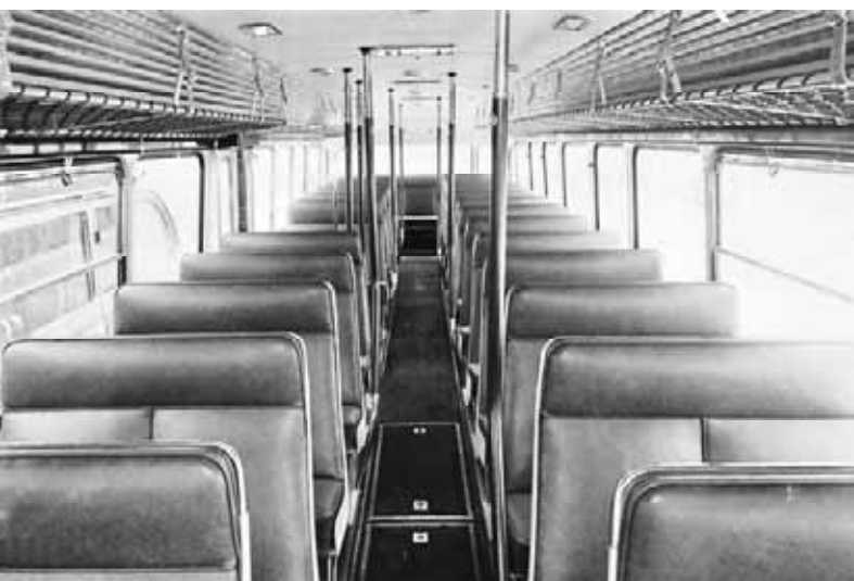
Interiør fra Volvo B658 leveret til DSB. Gennem lemmene i gulvet var der adgang til motoren. (Arkivfoto Peer Goe Jacobsen)
